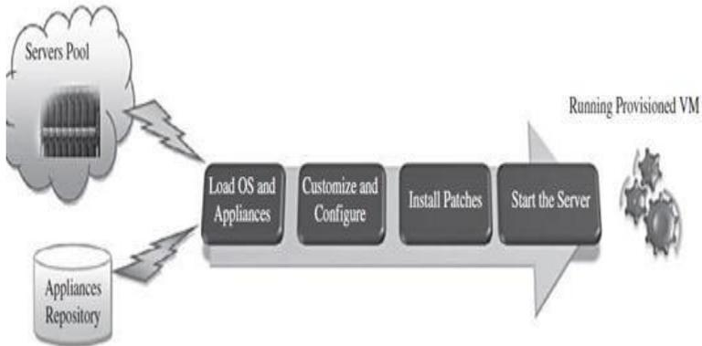
FIG.3.2 VIRTUAL MACHINE PROVISIONING PROCESS
